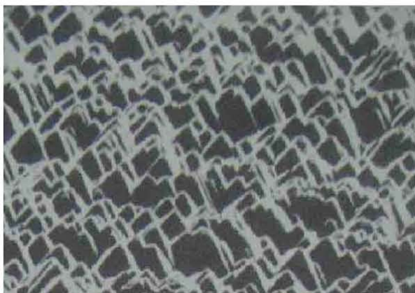
图6.4-3硅片表面绒面结构的扫描电镜图 图6.4-4 具有绒面结构的硅片表面反射示意图
